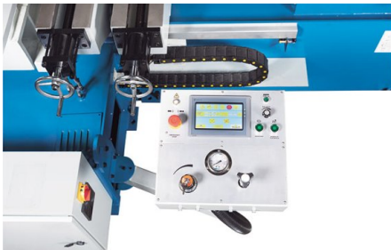
Ajustarea manuală a unghiurilor arcului de fierăstrău cu propulsie hidraulică ( 15°. 30° și 45°)
