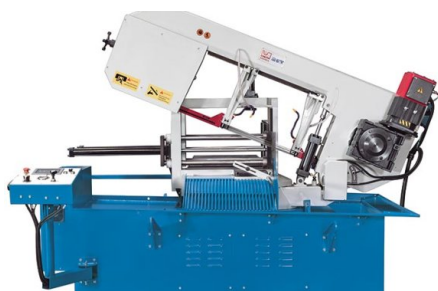
Una morsa doppia a portale a serraggio idraulico garantisce la massima stabilità, anche in caso di taglio di fasci
