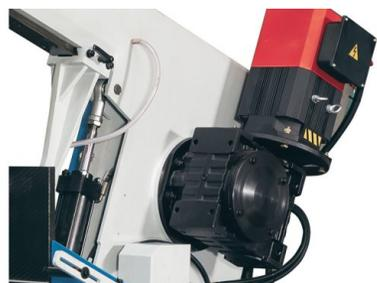
Velocidad de la correa infinitamente variable, accionada por un servomotor
