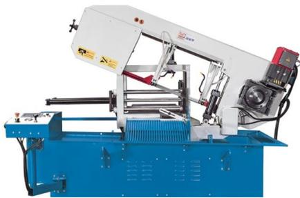
Los tornillos de banco de grúa doble hidráulico aseguran una máxima estabilidad, incluso durante el maquinado de paquetes
