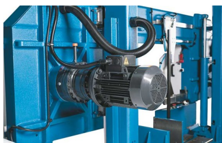
Mocny silnik napędu głównego, regulowany bezstopniowo
