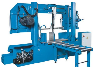
Il manometro assicura il tensionamento corretto della lama, per aumentarne la durata ed abbassare i costi
