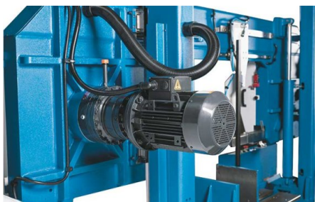
Potente motore d'azionamento a variazione continua
