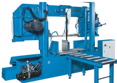
Indicator manometru pentru tensionarea corectă a lamei de fierăstrău - crește durata de viață a uneltei și scade costurile
