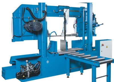
Indikace tlakoměru pro správné napnutí pilového pásu - prodlužuje životnost a snižuje náklady
