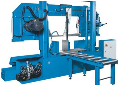
El manómetro asegura la tensión correcta de la hoja de la sierra para mayor vida útil de la hoja y menores costos
