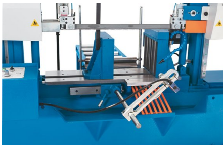
I rulli d'avanzamento motorizzati di fermano automaticamente alla fine del materiale
