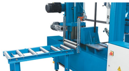
Stabile rulliera di carico ed alimentazione materiale per i fasci da tagliare
