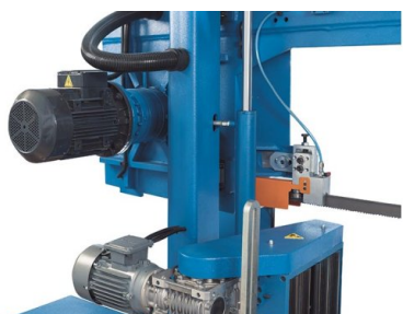
Мощные двигатели для пильного полотна и подающий привод скомбинированы с коробками передач, которые отвечают самым высоким требованиям и характеризуются низким уровнем шума и увеличенным ресурсом работы при максимальных нагрузках
