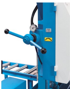
Manómetro para un tensado preciso de la hoja de sierra
