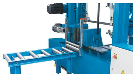
Rail stable d'acheminement à rouleaux et guidage de matière pour ensemble de pièces
