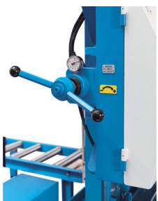
Manomètre pour une tension correcte de la lame de scie
