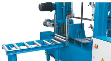
Stabilna prowadnica doprowadzająca i prowadnica materiału do wiązki detali
