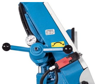
Гидравлический механизм зажима заготовки входит в стандартную комплектацию
