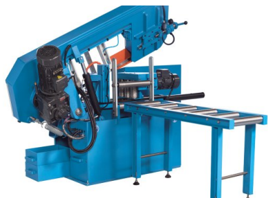
Мотор с плавной регулировкой скорости передает усилие на ведущее колесо станка через приводной шкив, рассчитанный на непрерывную эксплуатацию
