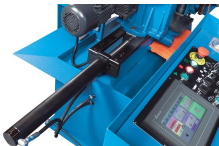
Гидравлический механизм зажима заготовки входит в стандартную комплектацию
