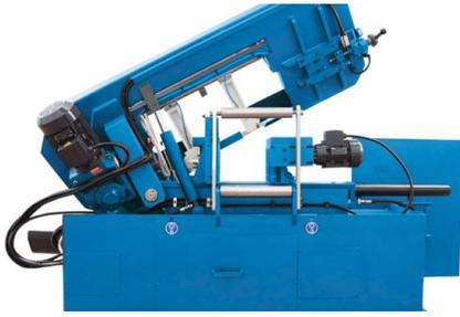
*Der stufenlos drehzahlregelbare Motor überträgt seine Kraft über ein für den Dauerbetrieb ausgelegtes Umlenkgetriebe auf das Antriebsrad der Maschine*
