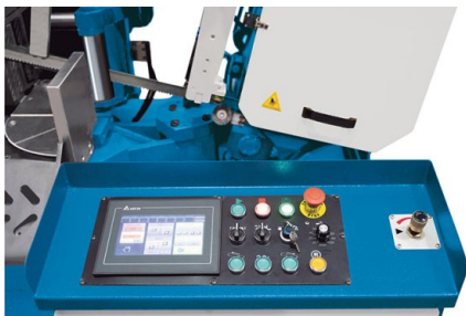
Сенсорный экран позволяет легко и наглядно выполнять программирование автоматического режима
