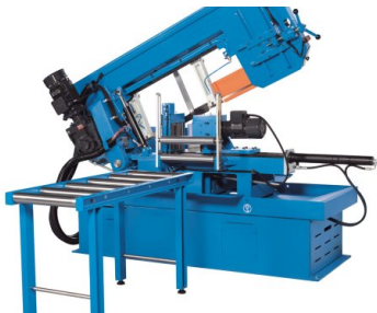
Una mesa de rodillos de alimentación forma parte del equipamiento estándar
