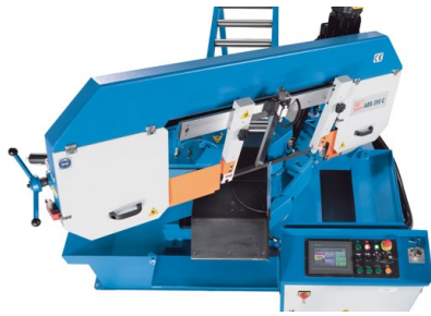
El bastidor de la sierra gira hasta 45° a ambos lados
