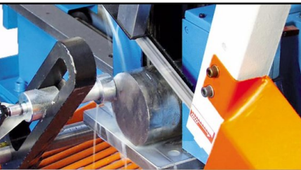
Limitación automática de subida del marco al completar el corte.
