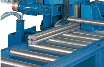
Se ofrece una prensa de conjuntos para cortar paquetes enteros de material en toda su longitud
