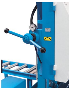
Манометр для правильного натяжения пильного полотна
