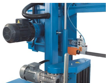
Die kraftvollen Motoren für Sägeblatt- und Vorschubantrieb sind mit Getrieben kombiniert, die den hohen Anforderungen in jeder Hinsicht gewachsen sind, geräuscharm, hoch belastbar und raumsparend
