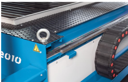
Le guide lineari e gli azionamenti a cremagliera a denti inclinati progettati per uso continuato sono poco soggetti all'usura e praticamente esenti da manutenzione
