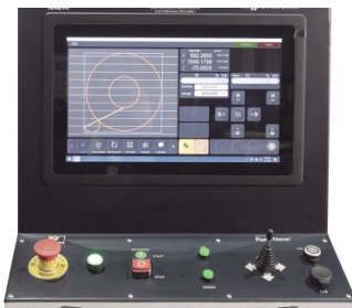
Die CNC Steuerung PULSER 3 mit 15"-Touchscreen ist für moderne Schneidanwendungen konzipiert und einfach zu bedienen
