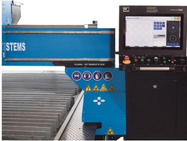
Unité CNC Eckelmann puissante avec écran tactile 19" ELO
