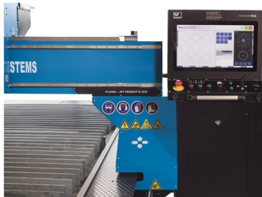
Leistungsstarke Eckelmann CNC-Einheit mit 19" Touchscreen von ELO
