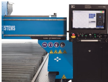
Potente unità di controllo CNC Eckelmann con touchscreen da 19" di marca ELO
