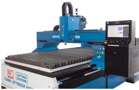
Diseño de puente con dos accionamientos y servomotores dinámicos de CA en todos los ejes
