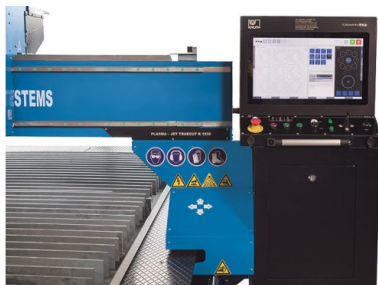
Výkonná CNC jednotka Eckelmann s 19" dotykovým displejem značky ELO
