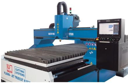
Brückenbauweise mit zwei Antrieben und dynamischen AC-Servoantrieben in allen Achsen
