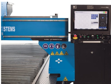
Leistungsstarke Eckelmann CNC-Einheit mit 19" Touchscreen von ELO
