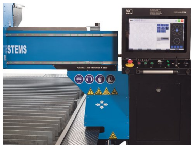
Potente unità di controllo CNC Eckelmann con touchscreen da 19" di marca ELO
