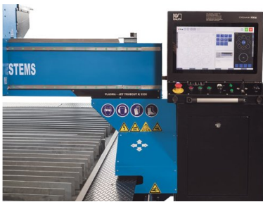
Мощный модуль ЧПУ Eckelmann с сенсорным экраном 19" фирмы ELO
