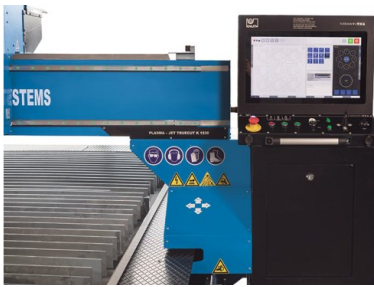
Unitate CNC Eckelmann de mare putere cu ecran tactil de 19" de la ELO
