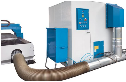
Staubabsaugung und Filteranlage als Option erhältlich
