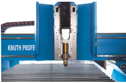
Schnellkupplung für Schneidkopf
