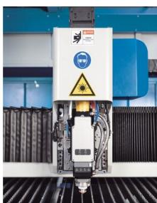
*Cabezal de corte con una protección contra colisiones integrada, posicionamiento de enfoque automático y control de altura*
