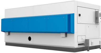
Для безопасности людей и окружающей среды система резки оснащена закрытым корпусом
