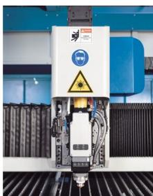
Tête de découpe avec protection anti-collision intégrée, réglage automatique de la position focale et réglage de la hauteur
