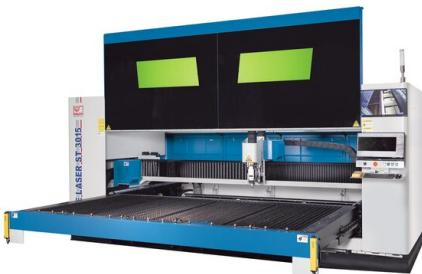
*Der Arbeitstisch ist auf einem besonders stabilen Auszug montiert, der im ausgefahrenen Zustand Werkstückgewichte von bis zu 1000 kg problemlos aufnehmen kann*
