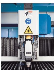
*Schneidkopf mit integriertem Kollisionsschutz, automatischer Fokuslagenverstellung und Höhenregelung*
