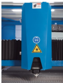
Inteligentní řezací hlavy řady BLT 6 byly také speciálně vyvinuty pro výkonné laserové systémy do max. 40 kW
