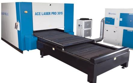
**Надежная автоматическая система сменных столов сводит к минимуму время подсобных работ, позволяя загружать и разгружать столы одновременно с выполнением резки**
