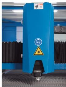
**Интеллектуальные режущие головки серии BLT 6 также были разработаны специально для лазерных систем высокой мощности (до 40 кВт).**
