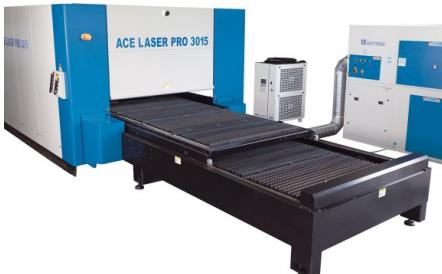
*Le robuste système de table à changement automatique minimise les temps accessoires de fabrication en permettant le chargement et déchargement de la table pendant le processus de découpe.*
