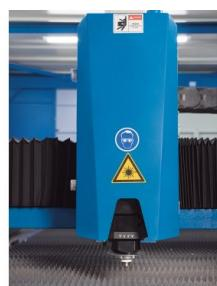
*Les têtes de découpe intelligentes de la série BLT 6 ont également été spécialement conçues pour les installations laser haute performance jusqu'à 40 kW max.*
