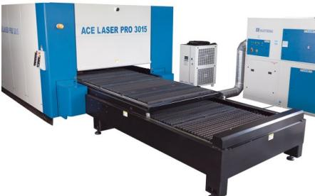
*Le robuste système de table à changement automatique minimise les temps accessoires de fabrication en permettant le chargement et déchargement de la table pendant le processus de découpe.*
