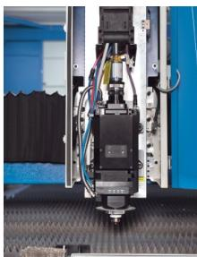
*Un diseño de recorrido de viga completamente nuevo con lentes optimizados y un colector de polvo doble garantiza un rendimiento de corte confiable y también un armado y un mantenimiento sencillos*
