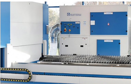
La máquina incluye un separador de polvo y una unidad de filtración con una eficacia del 99,997 %.
