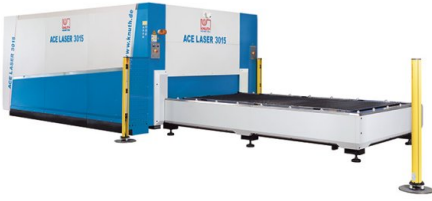
Автоматическая система сменных столов со световыми защитными барьерами
