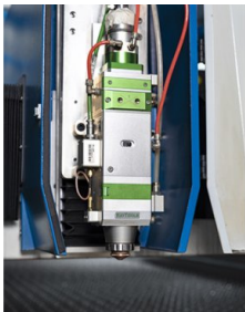
Cabezal de corte de alta calidad con Autofokus de RayTools
