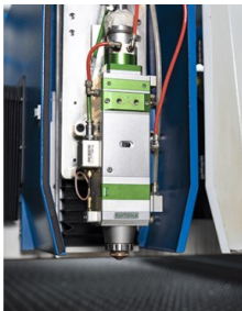
Wysokiej jakości głowica pomiarowa z automatycznym ustawianiem ostrości firmy RayTools
