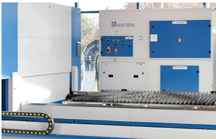
La machine est équipée de série d'un séparateur de poussière et d'une unité de filtration, et garantit une efficacité de 99,997 %
