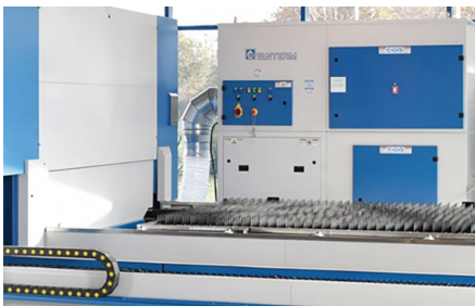
Die Maschine ist standardmäßig mit einem Staubabscheider und einer Filtrationseinheit ausgestattet und hat eine 99,997%ige Effizienz
