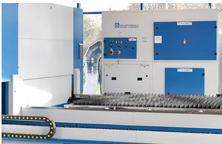
В стандартной комплектации станок оснащен пылеуловителем и модулем фильтрации с эффективностью 99,997 %
