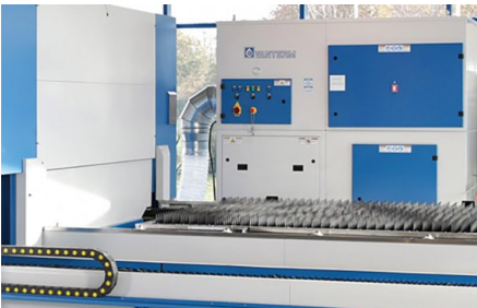
La macchina è dotata di serie di un separatore di polvere e di un'unità di filtrazione con un'efficienza del 99,997
